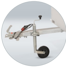
Gerade Rohrdeichsel bei einer Breite von 101 cm
