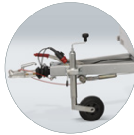
V-Deichsel aus U-Profil bei einer Breite von 126 cm
