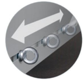
Integrierte Schiene im Laderaum zur Ladungssicherung
